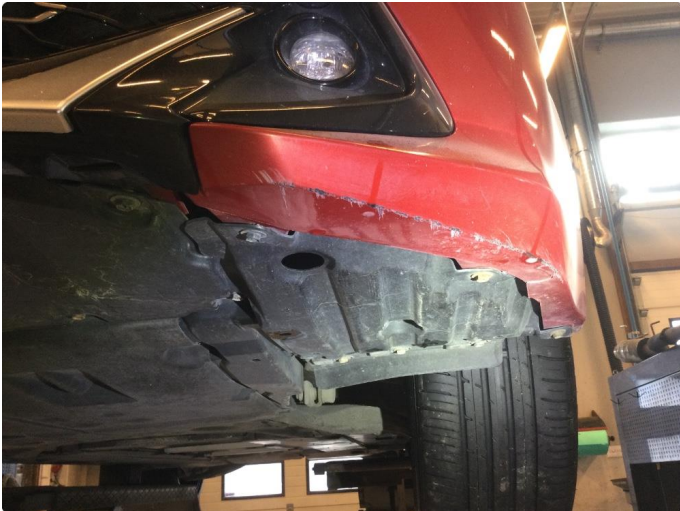
1.2 Skrubbskader underkant støtfanger
