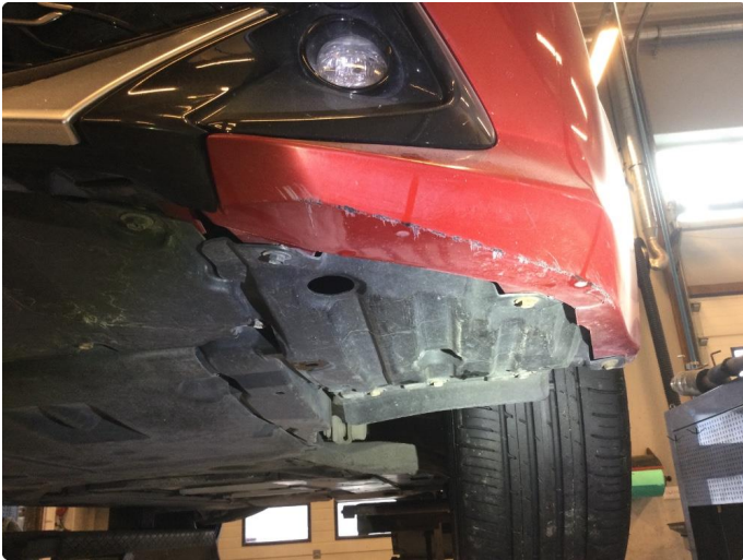
1.2 Skrubbskader underkant støtfanger
