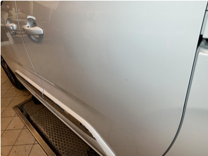
1.1 Noen riper og småbulker
