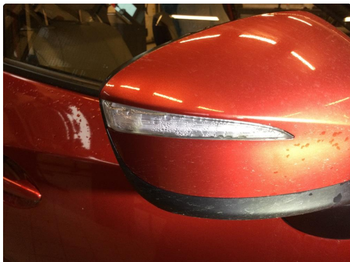
1.4 Blinklys noe fukt
