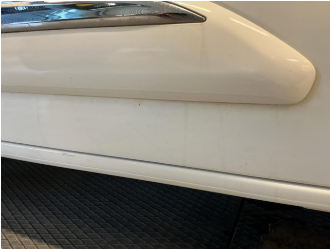
1.1 Er noen steinsprang med overflaterust
