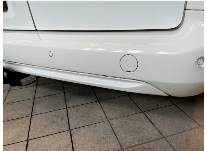
1.1 Er noen steinsprang med overflaterust
