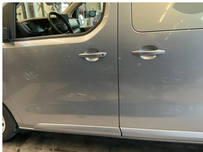
1.1 Ripe ned til grunning
