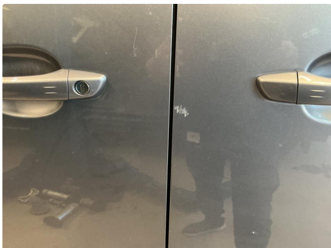
1.1 Ripe ned til grunning
