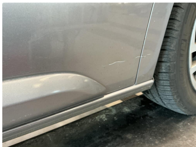
1.2 Ripe ned til grunning
