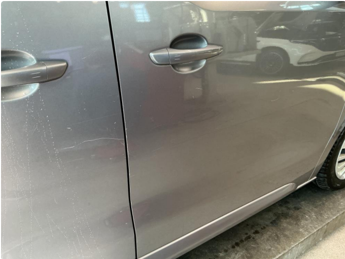
1.1 Ripe ned til grunning
