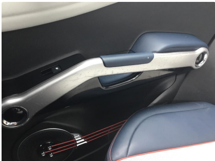
2.1 Riper og merker på dørhåndtak fra innsiden av bilen. Høyre side.
