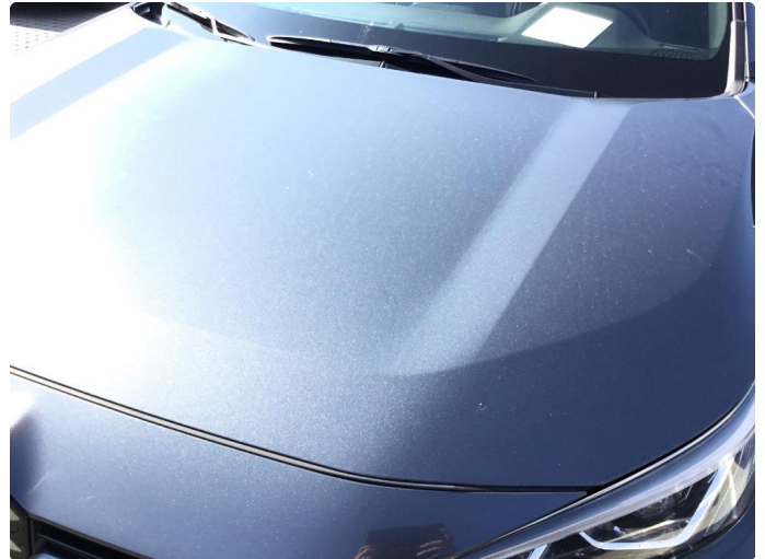
1.2 Litt steinsprut på panser
