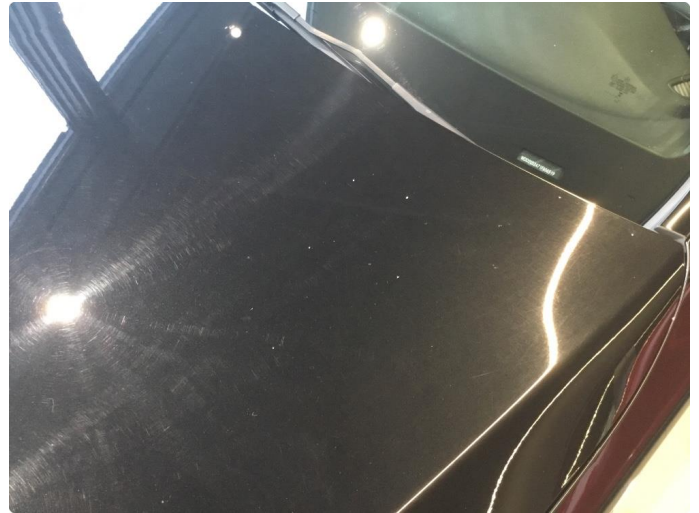
1.1 Diverse steinsprut på panser
