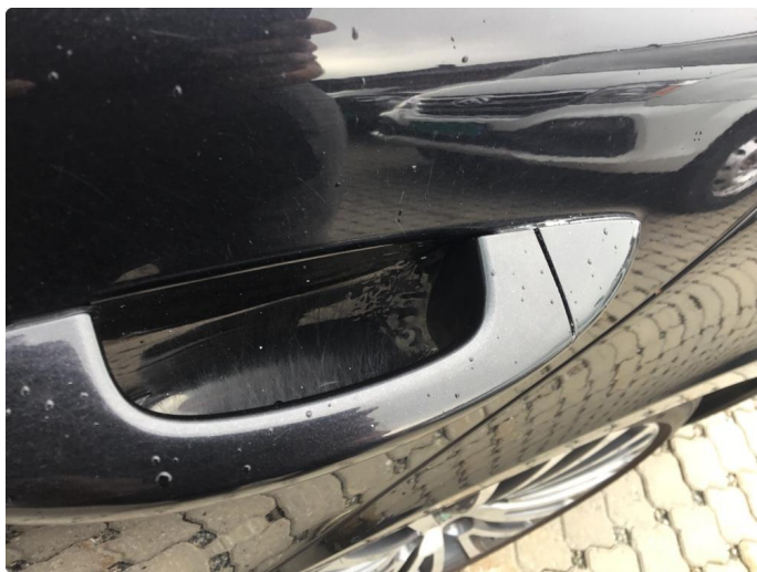
1.9 Rust på dørhåndtak
