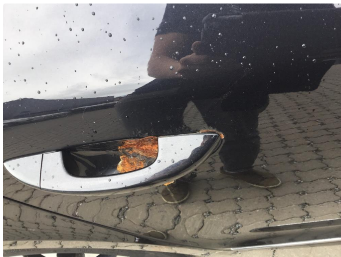
1.5 Rust på dørhåndtak
