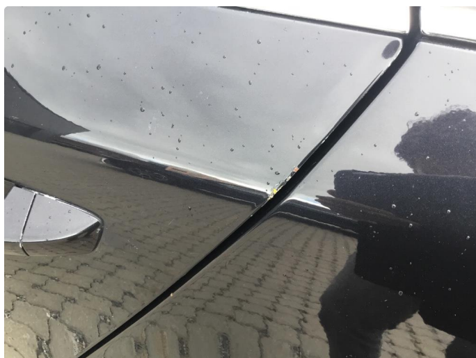
1.9 Rust på dørhåndtak
