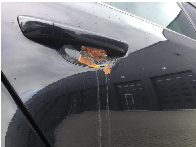
1.5 Rust på dørhåndtak
