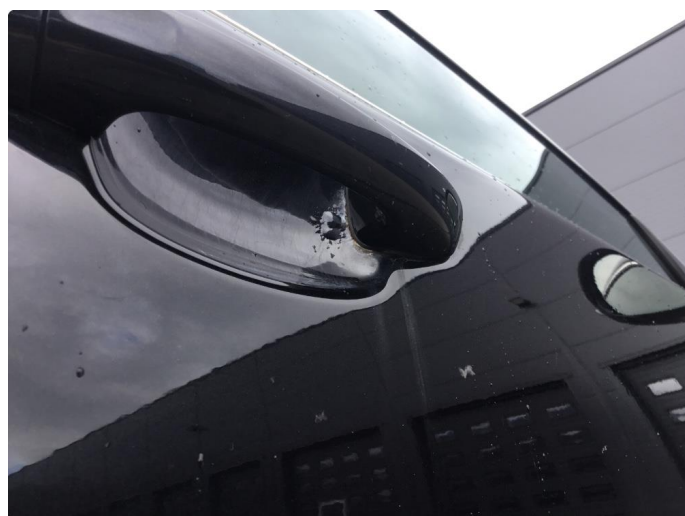
1.4 Rust på dørhåndtak
