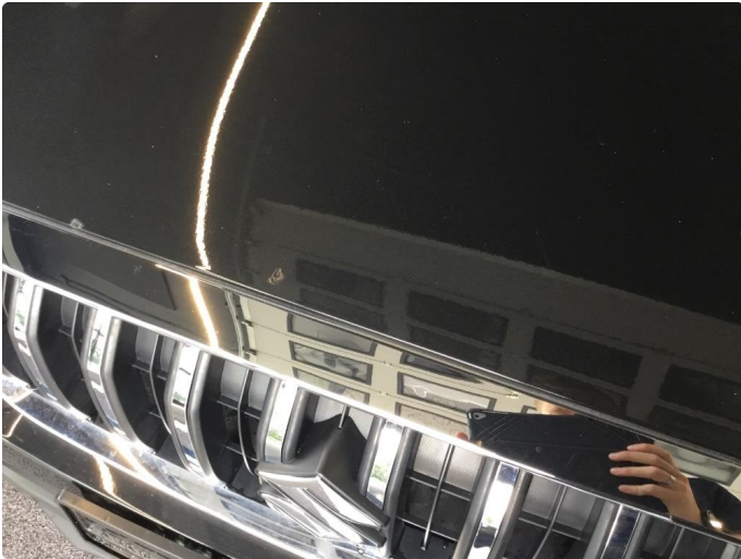
1.1 Steinsprut og litt rust på panser
