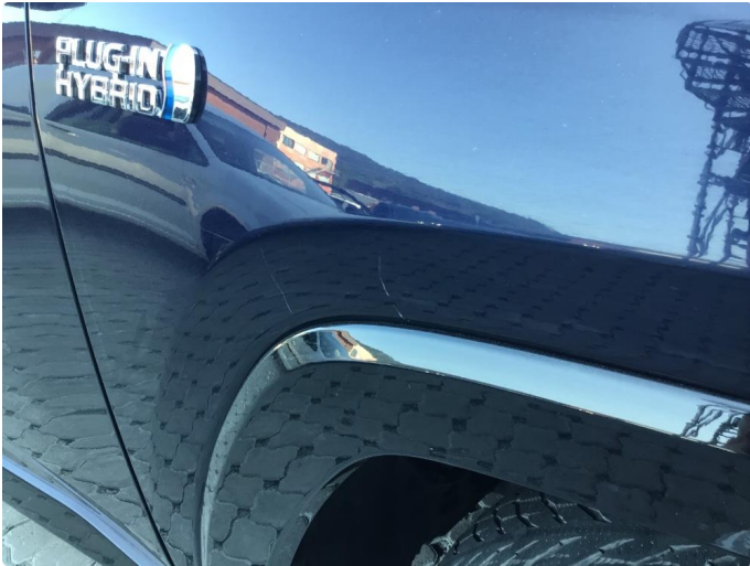
1.1 Ripe(r) ned til grunning
