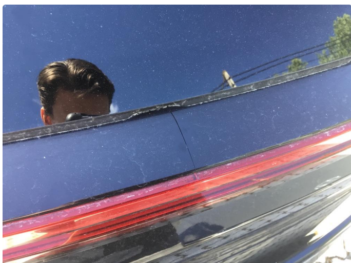
1.2 Sprekk under bakvindu
