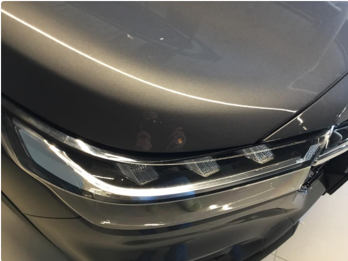
1.1 Noe steinsprut med rust
