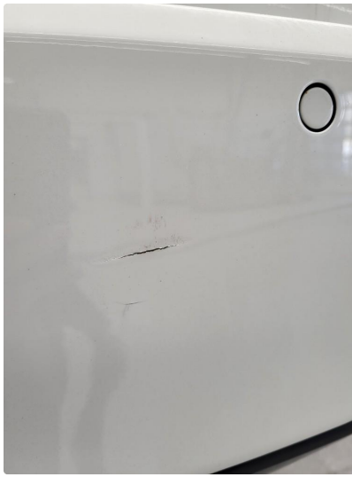
1.3 Ripe(r) ned til grunning
