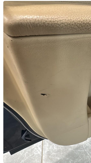
4.1 Hull i dørtrekk førerdør og passasjerdør foran
