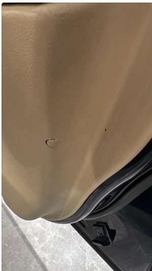
4.1 Hull i dørtrekk førerdør og passasjerdør foran
