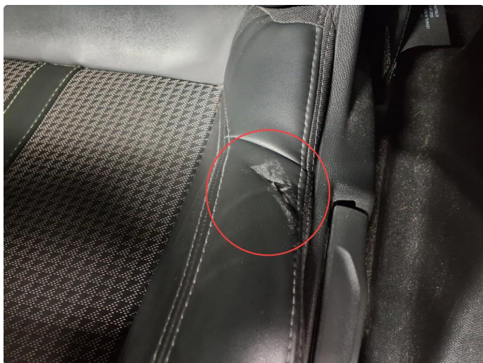
4.1 Skade på setetrekk
