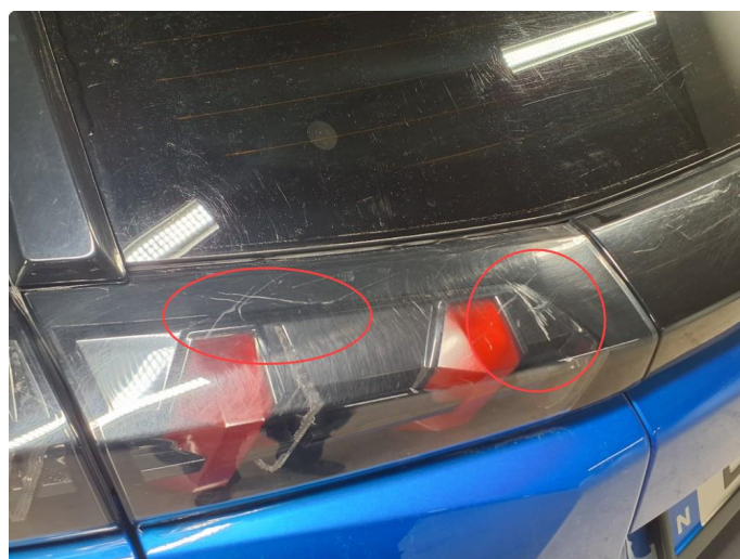
3.1 Ripper på baklykt
