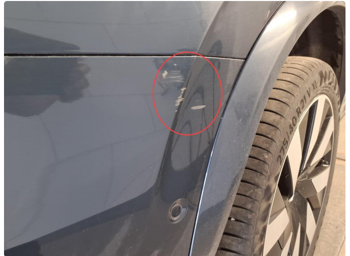
1.2 Ripe(r) ned til grunning ved hjulbuen høyre bak
