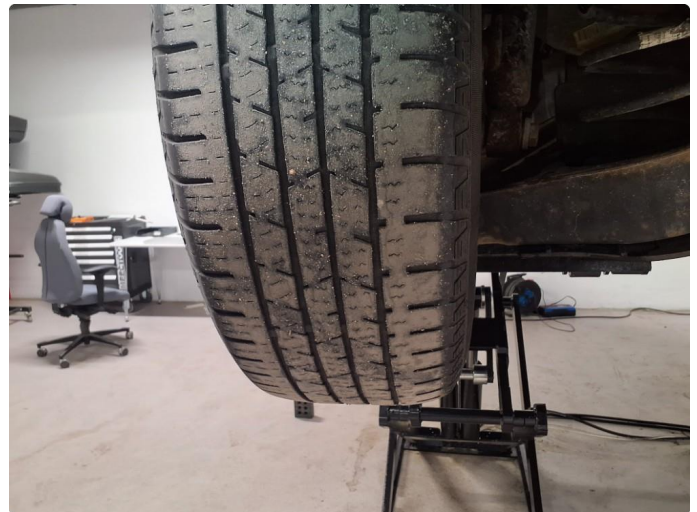
1.4 Skjev slitasje på sommerdekk
