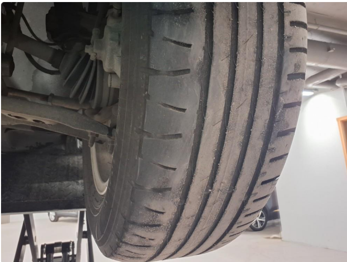
1.4 Skjev slitasje på sommerdekk
