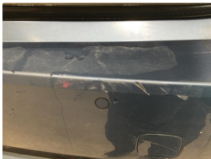
1.2 Riper og bruksslitasje på støtfanger
