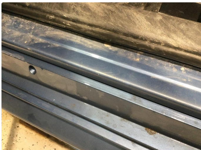
1.1 Slitasje på innsteg, og bulk i døråpning
