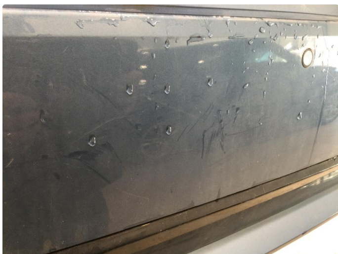
1.2 Riper og bruksslitasje på støtfanger
