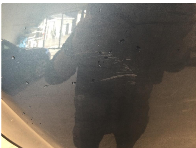
1.2 Riper og bruksslitasje på støtfanger
