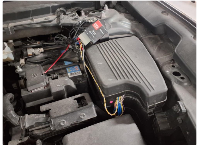
2.1 Ufagmessig montert ledningsnett til ekstralys Lazer
