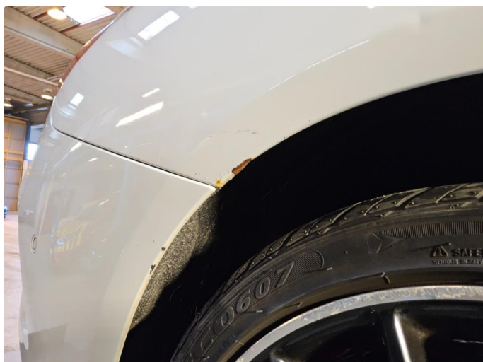
1.1 Noe korrosjon - Bakluke og begge skjermer bak.
