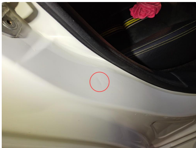
1.4 Riper - Normal bruksslitasje
