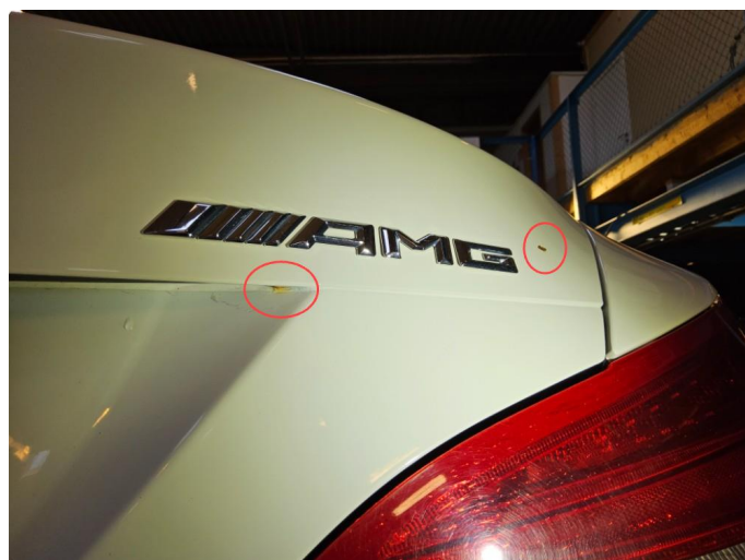
1.1 Noe korrosjon - Bakluke og begge skjermer bak.
