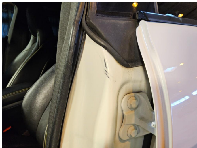
1.4 Riper - Normal bruksslitasje
