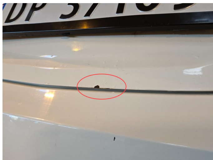
1.1 Noe korrosjon - Bakluke og begge skjermer bak.
