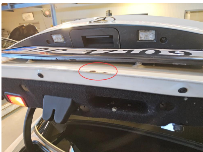
1.1 Noe korrosjon - Bakluke og begge skjermer bak.
