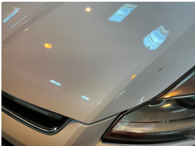
1.1 Ripe i hjørnet på panser, ikke rust.
