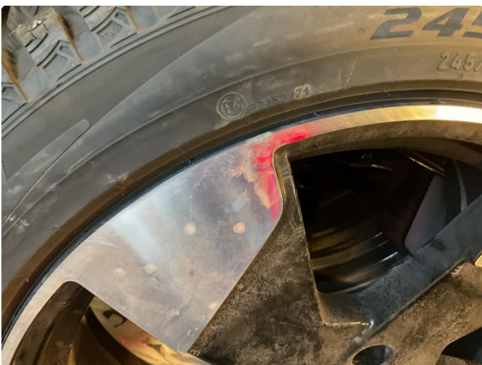
1.1 Merke på felg høyre foran
