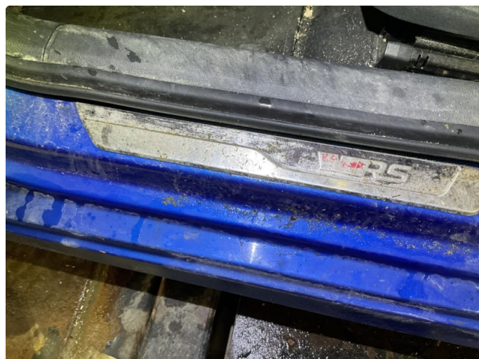
1.1 Noe slitasje innsteg begge side foran.
