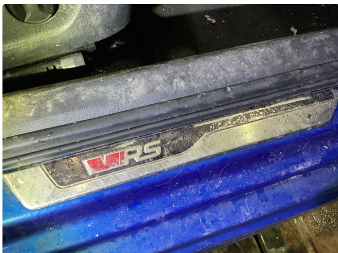
1.1 Noe slitasje innsteg begge side foran.
