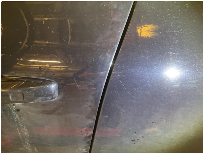
1.1 Ripe ned til grunning
