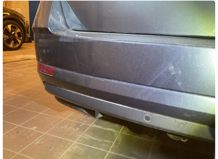
1.1 Noe bruksmerker på støtfanger bak.
