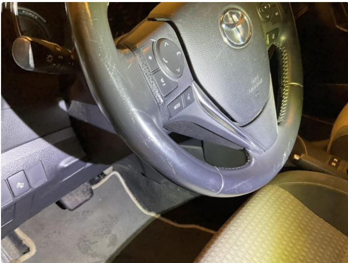
1.2 Noe slitasje på ratt. Fremstår som normalt iht alder/km.stand
