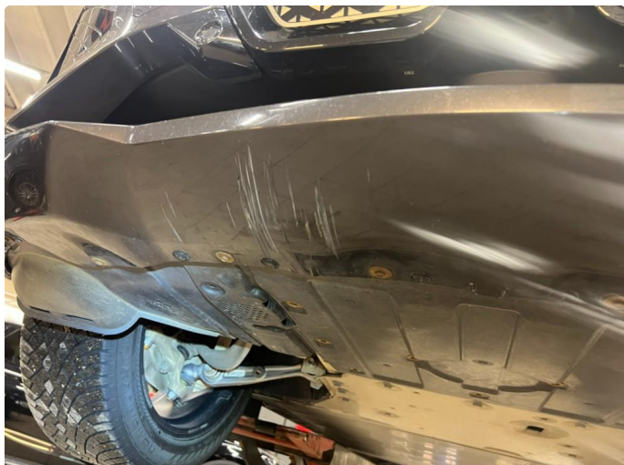
1.1 Noe skrubbskade underkant frontfanger. Fremstår ikke sjenerende
