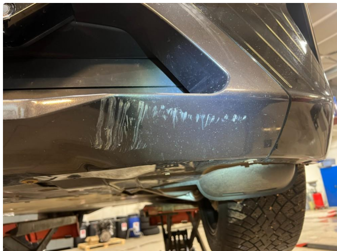
1.1 Noe skrubbskade underkant frontfanger. Fremstår ikke sjenerende
