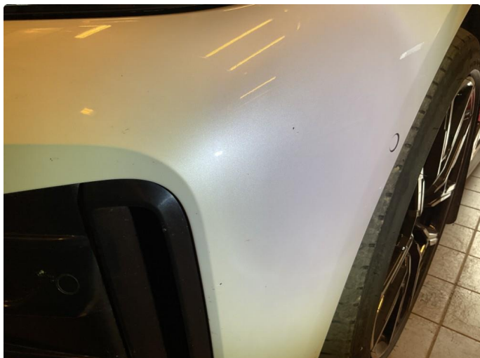
1.1 Noe små steinsprut i front
