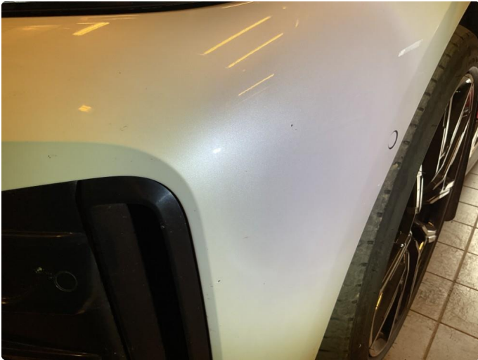
1.1 Noe små steinsprut i front
