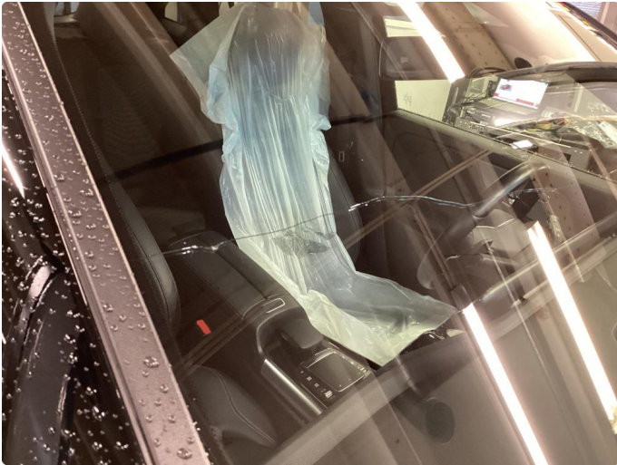
1.1 Steinsprut med sprekk
