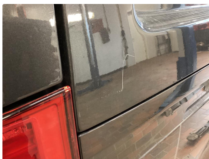
1.2 Ripe(r) ned til grunning
