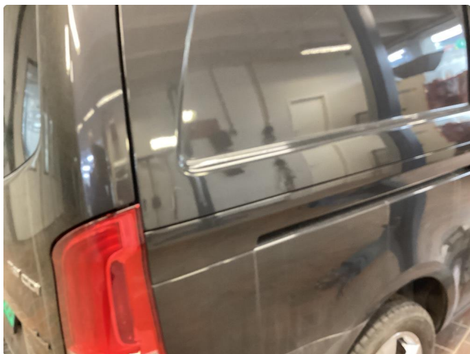
1.2 Ripe(r) ned til grunning
