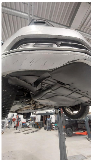
1.1 Noen riper og småbulker
