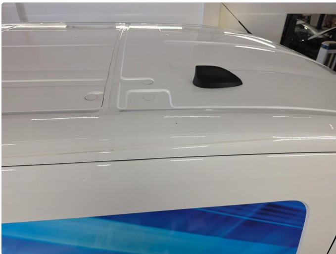
1.2 Bulk med lakkskade
