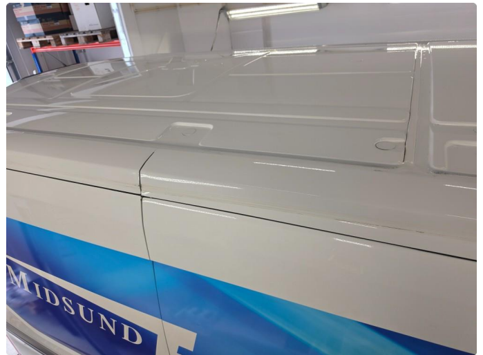
1.2 Bulk med lakkskade
