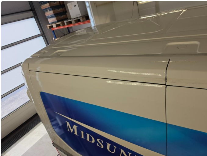
1.2 Bulk med lakkskade
