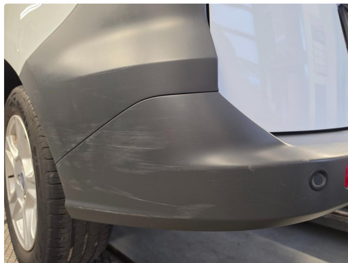
1.1 Noen riper og småbulker
