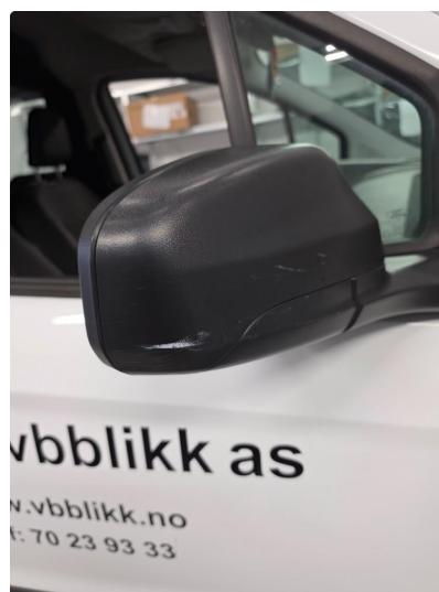
1.1 Noen riper og småbulker
