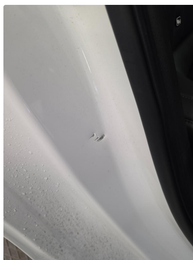
1.1 Noen få steinsprut
