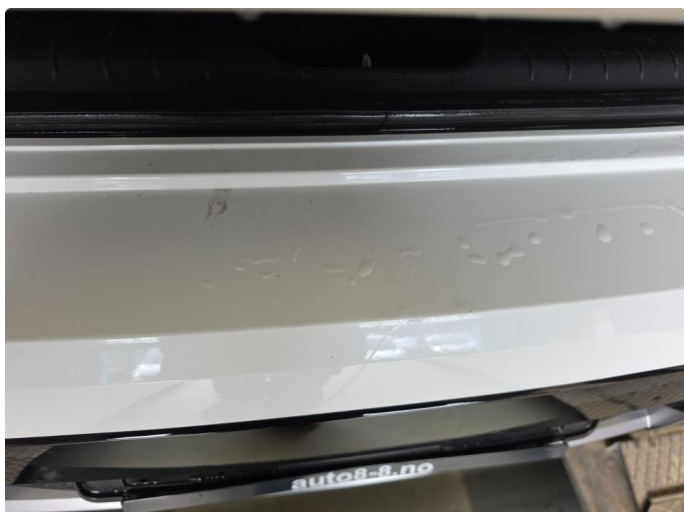
1.1 Noen få steinsprut
