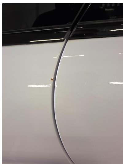
1.1 Noen få steinsprut
