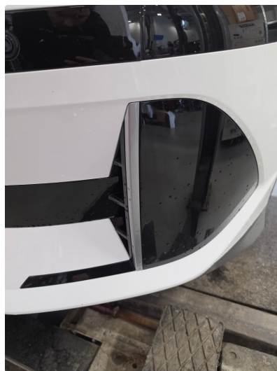
1.1 Noen få steinsprut
