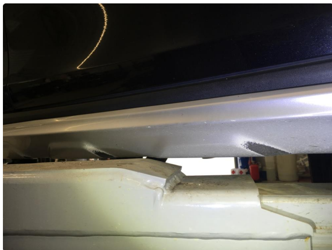
1.1 Noen riper og småbulker
