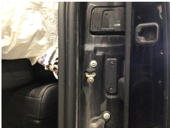
1.2 Rust/korrosjon i skruer på dørhengsel
