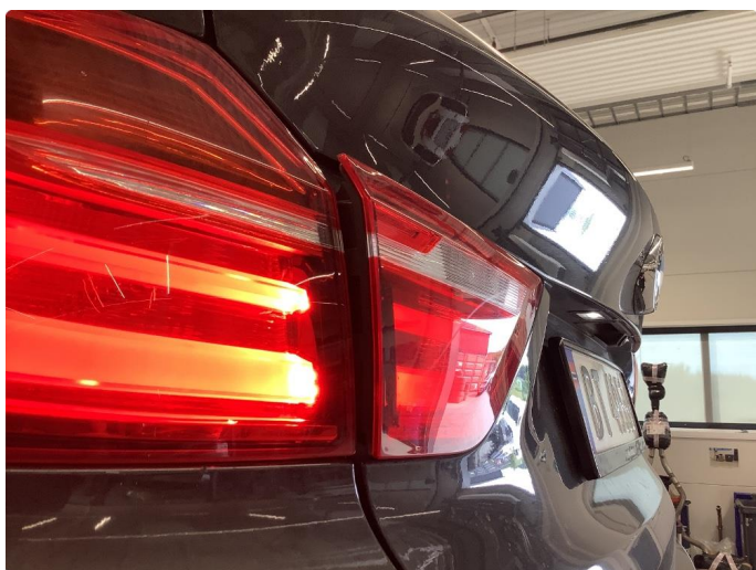
2.1 Defekt / sprukket glass
