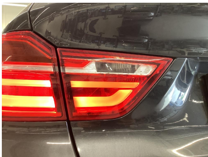
2.1 Defekt / sprukket glass
