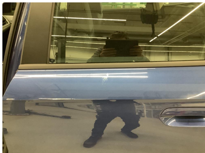
1.1 Forurensing lakk ytre påvirkning
