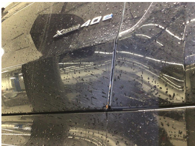
1.2 Steinsprut med rust
