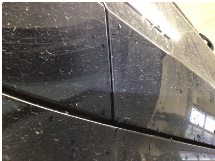
1.2 Steinsprut med rust
