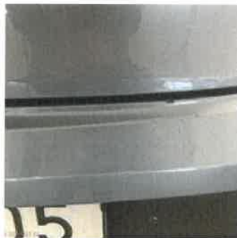
Skadebild Repor bakre stötdämpare
