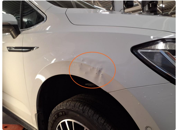
1.3 Skade - denne repareres før slag
