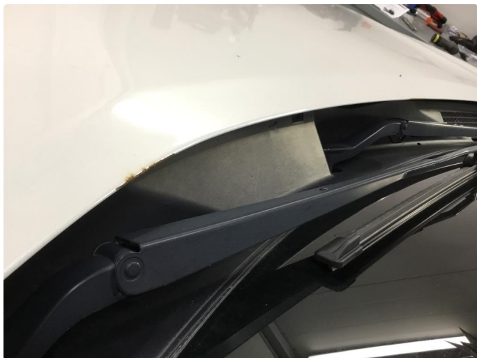
1.2 Noe rust i kanten av panser
