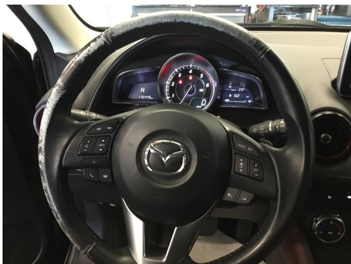
3.1 Slitasje på ratt
