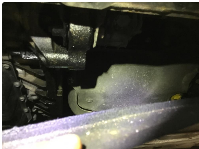
2.1 Oljelekkasje fra motor, under feilsøk
