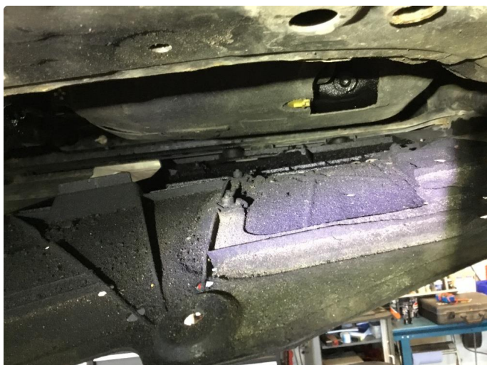
2.1 Oljelekkasje fra motor, under feilsøk
