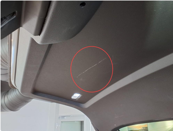
2.1 Skadet/merker etter utstyr
