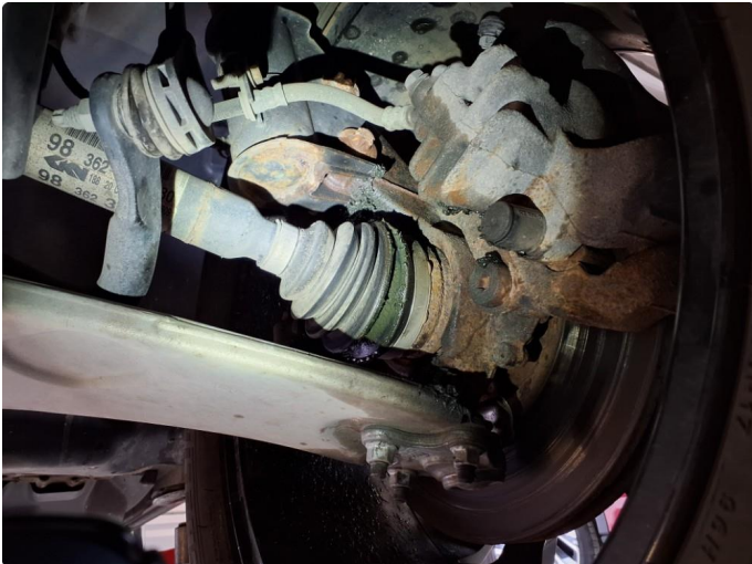
2.1 Drivakselmansjett defekt. Blir utbedret.
