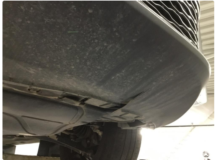
1.1 Liten sprikk i forntfanger venstre side
