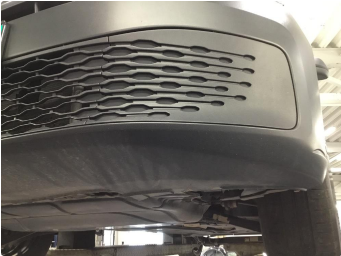
1.1 Liten sprikk i forntfanger venstre side
